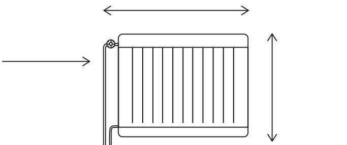
Messen Sie Folgendes: Abstände von anderen Objekten zum Heizkörper; Breite und Höhe des Heizkörpers.
