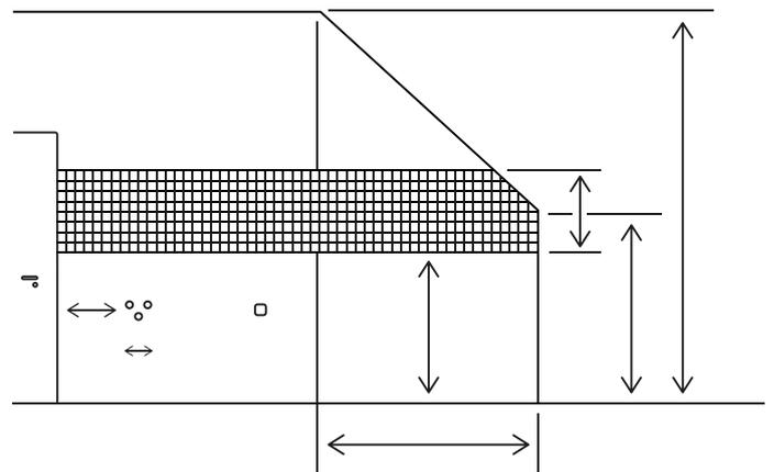
Messen Sie Folgendes: Raumhöhe, eventuelle Dachschrägenhöhe, Abstand von Fliesen zu Boden und Fliesenhöhe. Zeichnen Sie Herdanschluss, Wasseranschluss und Abstände zu anderen Objekten an.
